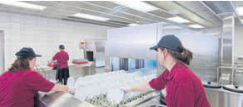
So gelangt Geschirrwärme von rund 80 °C nicht in die Raumluft, sondern wird dank wärmedämmter Tellerspender energieeffizient als Tellerrestwärme für die nächste Ausgabe genutzt. Fotos: Netzwerk Culinaria
