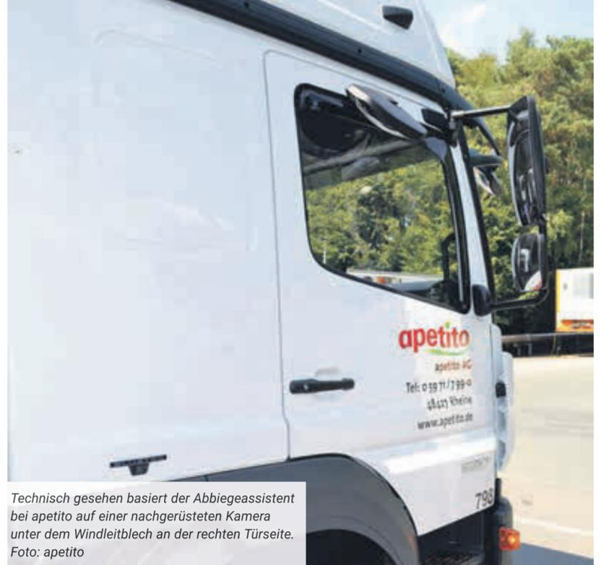
Technisch gesehen basiert der Abbiegeassistent bei apetito auf einer nachgerüsteten Kamera unter dem Windleitblech an der rechten Türseite. Foto: apetito
